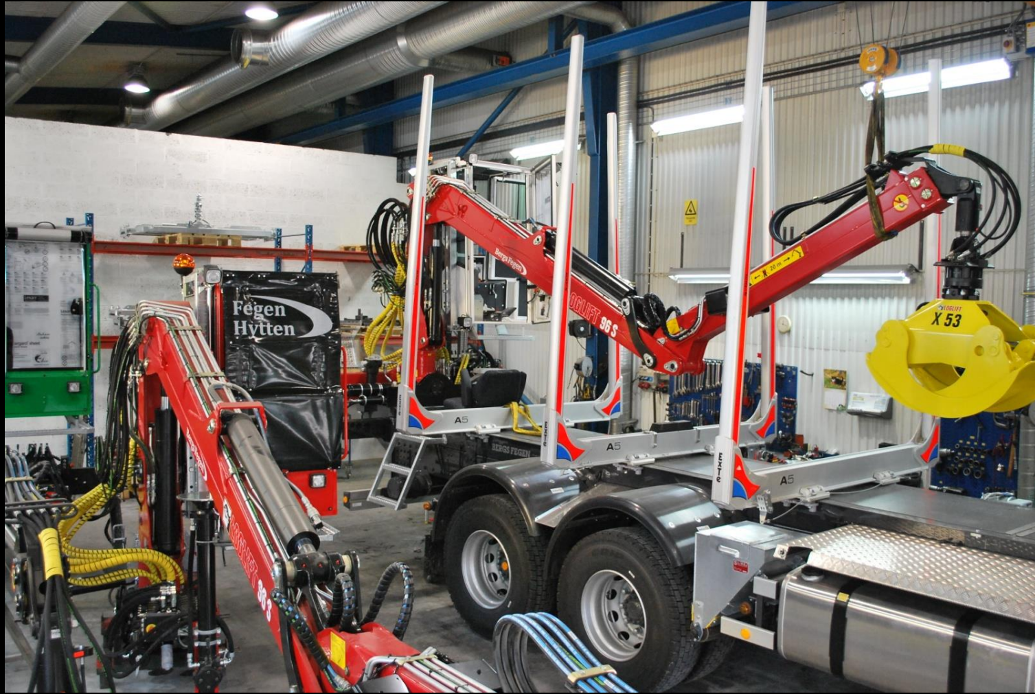
Hytt- och kranmontering
